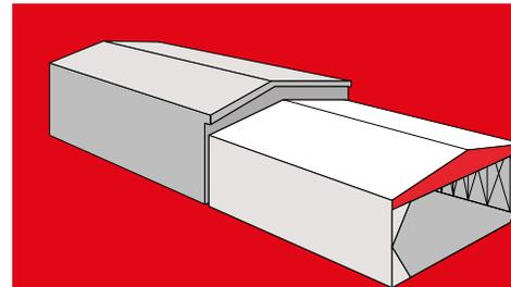
Le coperture frontali, sia mobili che fisse, vengono ancorate con uno dei due fronti a ridosso di una parete dello stabile esistente, mentre la parte restante viene estesa nella sua lunghezza sul resto del piazzale. Questa tipologia di copertura offre il vantaggio di poter effettuare le operazioni di carico/scarico delle merci al coperto.
