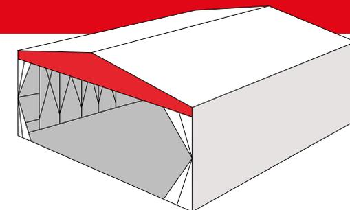
Questa tipologia di struttura rappresenta la migliore soluzione logistica per aumentare lo spazio coperto necessario ad un'azienda, da utilizzare come magazzino o reparto produttivo per lavorazioni particolari. Sono capannoni con manto in PVC costituiti da una *struttura autoportante* che non necessita di alcun collegamento fisico con fabbricati esistenti.
