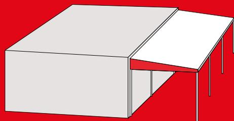
Le tettoie mobili Monofalda Sospesa vengono montate con uno o entrambi i lati a ridosso di fabbricati esistenti. Lo scorrimento è garantito da una coppia di guide parallele tra loro, montate su due travi in carpenteria, sostenute da una serie di colonne con interasse indicativo tra i 5 e 6 metri.
