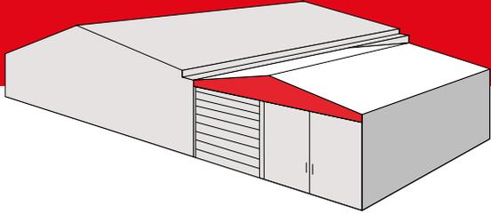
I capannoni mobili Bipendenza Laterale vengono montati con uno dei lati *a ridosso di fabbricati esistenti* oppure liberi a piazzale. Sono specifici per aumentare lo spazio coperto necessario ad un'azienda da utilizzare come magazzino o reparto produttivo per lavorazioni particolari.
